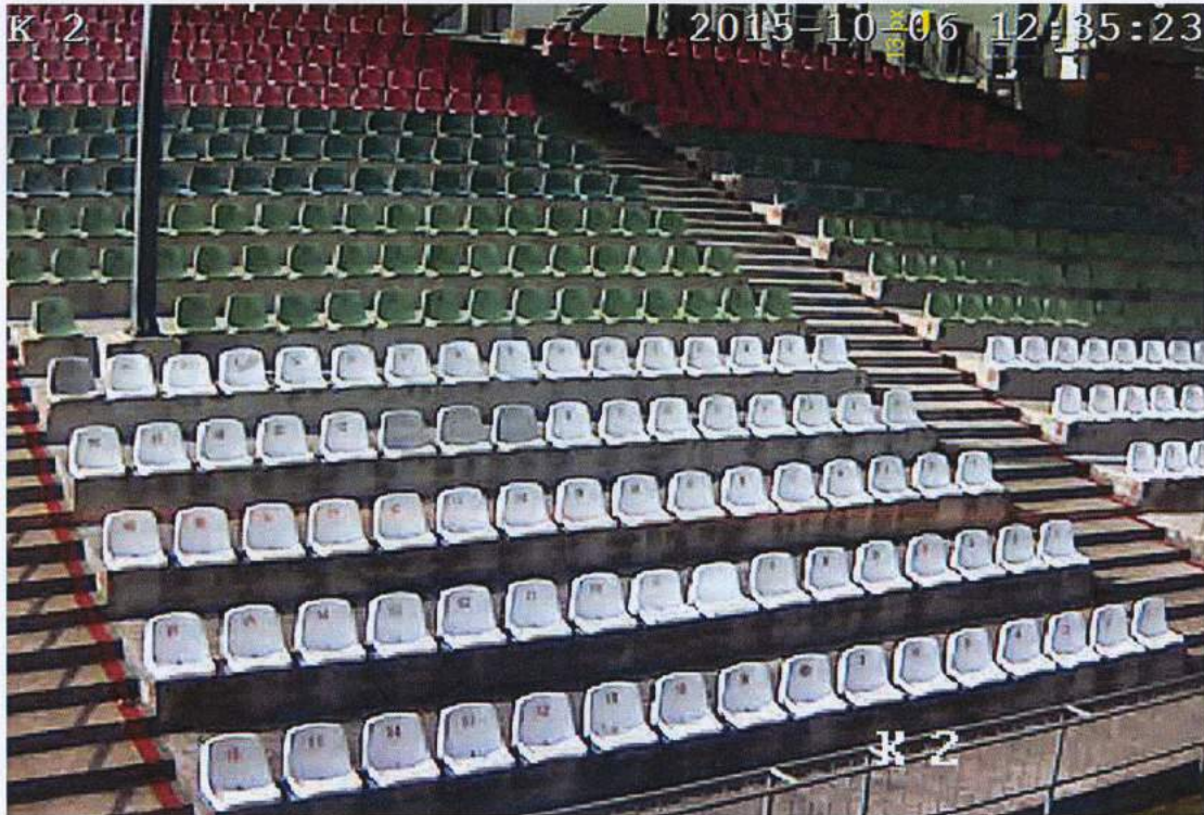
Numer porządkowy miejsca ustawienia obiektu testowego 9, kamera 2, obraz spełnia wymogi kategorii IV, sektor C nie jest w całości nadzorowany
