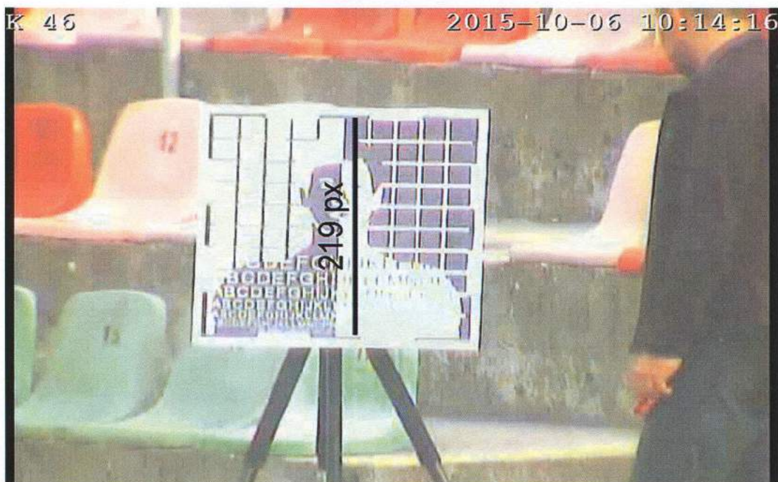
Numer porządkowy miejsca ustawienia obiektu testowego 29, kamera K 46, obraz nie spełnia wymogów kategorii II
